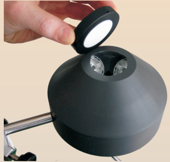
Messkopfadapter mit Keramik-Weiss-Standard
