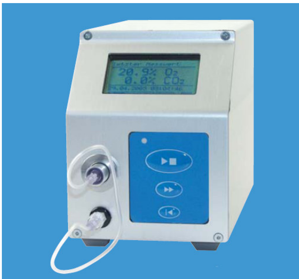
Telepített, laboratóriumi vagy üzemi védőgázcsomagolás ellenőrző műszer PA család
